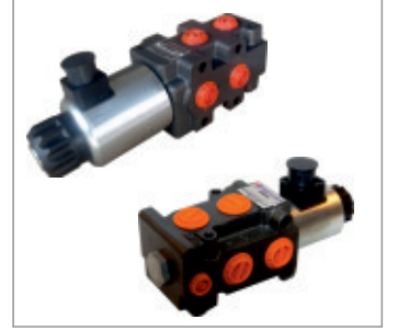
6 Yollu Elk. Kumandalı Valfler Debi 50-80 ci / dk Çalışma Basıncı 300 bar
